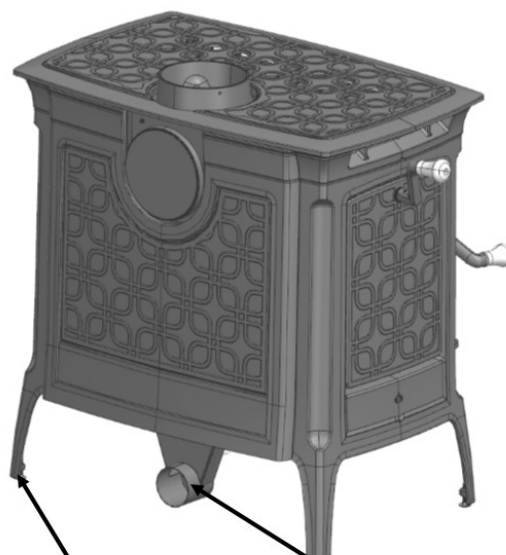
Conexión aire exterior
